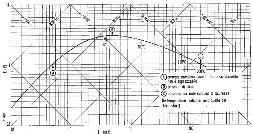
Fig. 2 - La posizione più interessante per le applicazioni è quella al di là del punto B, cioè la zona a coefficiente di temperatura negativo.
