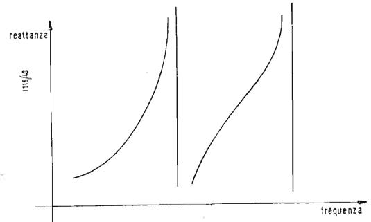
Fig. 7 - Andamento qualitativo della reattanza dell'impedenza di carico posteriore dell'altoparlante montato in un mobile chiuso, non rivestito internamente di materiale acustico assorbente. L'andamento riportato riguarda le alte frequenze.
