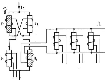
Fig. 5 - Analogo di fig. 2 costituito con sette cryotron.
