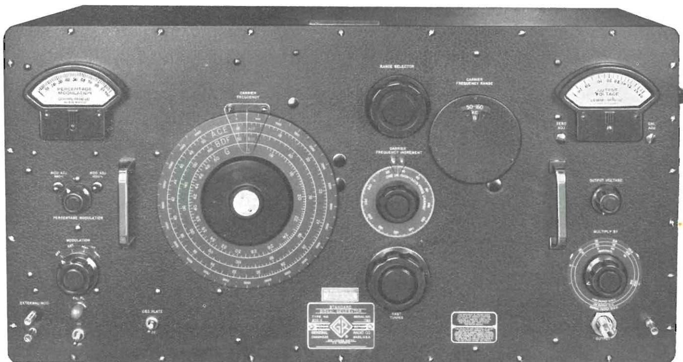
Abbiamo già descritto (Settembre 1958, 9, pagg. 394 e segg.) uno dei famosi generatori standard della General Radio Co.: il mod. 1001-A. Si trattò allora di uno strumento prevalentemente adatto a misure di controllo e di collaudo. Questo, che qui descriviamo, è invece un tipo avente caratteristiche che lo rendono adatto al lavoro di laboratorio. La gamma di copertura è la stessa che nel tipo 1001-A ma la precisione di taratura è molto migliore e le irradiazioni molto inferiori.
