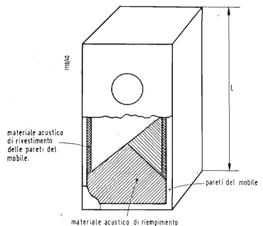
Fig. 8 - Esempio di mobile per altoparlanti completamente chiuso, rivestito internamente di materiale acustico assorbente e con un parziale riempimento di materiale acustico leggero, a forma di cono.
