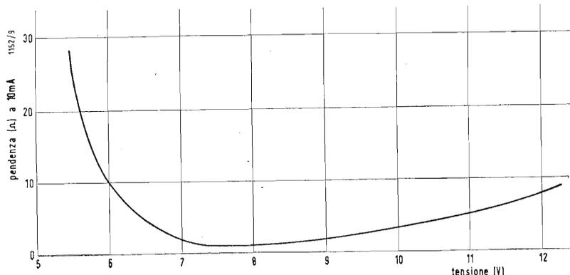
Fig. 7 - Diodi Zener: andamento della pendenza dinamica nel campo da 5 a 12 V.
