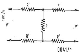
Le connessioni dovranno essere eseguite il più breve possibile. Riportando come primo valore quella di R' e come secondo quello di R'', diamo qui di seguito alcuni valori in ohm delle resistenze da usare per alcuni K.
