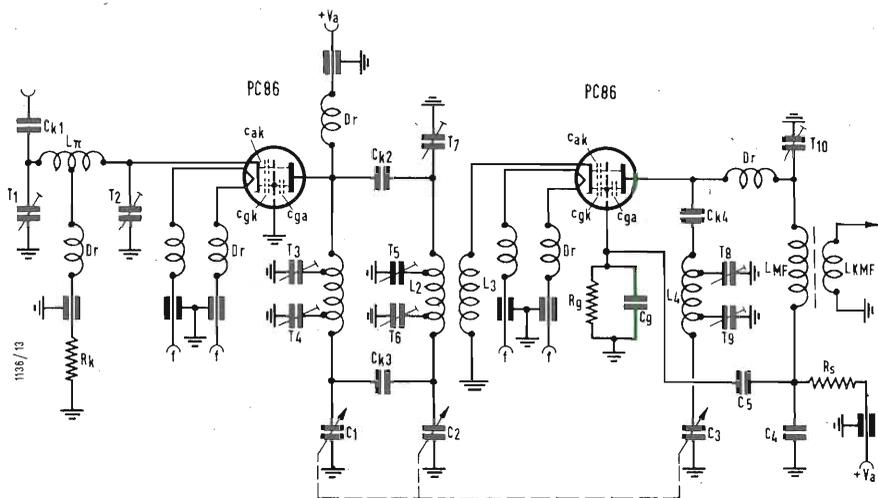
Fig. 2 - Circuito completo ad elementi concentrati.
