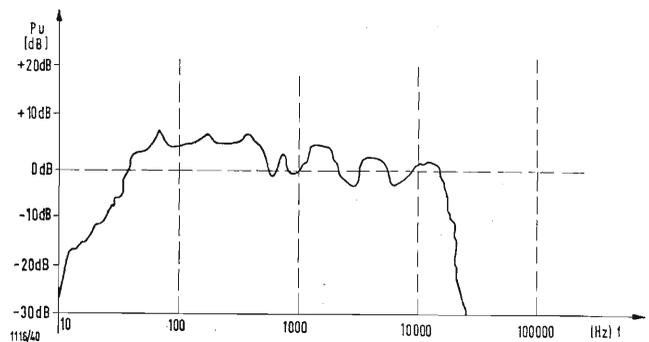
Fig. 2 - Andamento qualitativo della curva di risposta alle frequenze di un altoparlante montato in un mobile opportunamente studiato. Notare l'andamento discontinuo, frastagliato, della curva.
