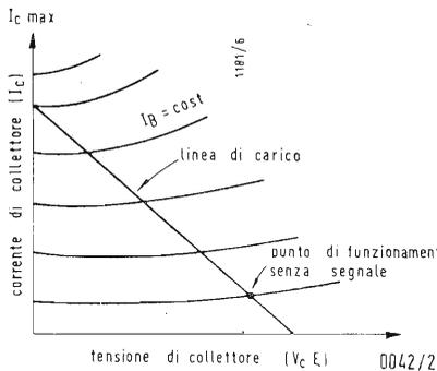
Quindi con il transistoro da Lei usato, del tipo 2N18FA, è possibile ottenere potenze di uscita dell'ordine di 0,8 W.
