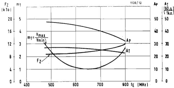
Fig. 9 - Adattamento in entrata, fattore di rumore e amplificazione di potenza del sintonizzatore con 2 PC86 in funzione della frequenza di entrata.
