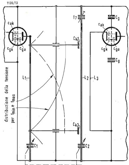
Fig. 6 - Funzionamento dell'accoppiamento del filtro.
