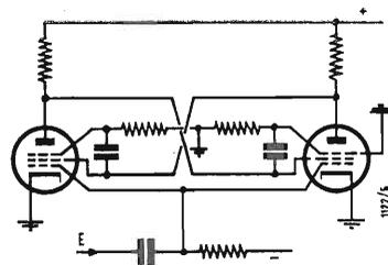
Fig. 3 - Circuito elettronico a anticoincidenza detto flip-flop.
