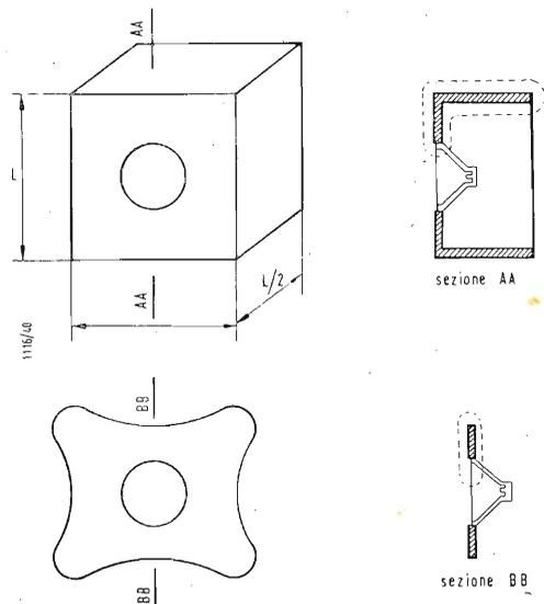
Fig. 4 - Mobile aperto sul retro, equivalente ad un « baffle » piano, tale che, in tutte le direzioni il cammino (tratteggiato) per andare dal retro al fronte dell'altoparlante, sia uguale. Le scale per i due disegni non sono ovviamente uguali.
