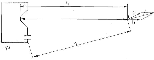
Fig. 16 - La pressione sonora in un punto P, dovuta alle onde emesse da un mobile bass-reflex, è pari alla somma vettoriale delle pressioni sonore dovute all'altoparlante e all'apertuta.
