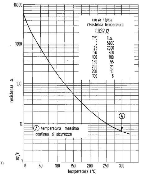
Fig. 1 - Andamento della resistenza di un termistore con la temperatura.
