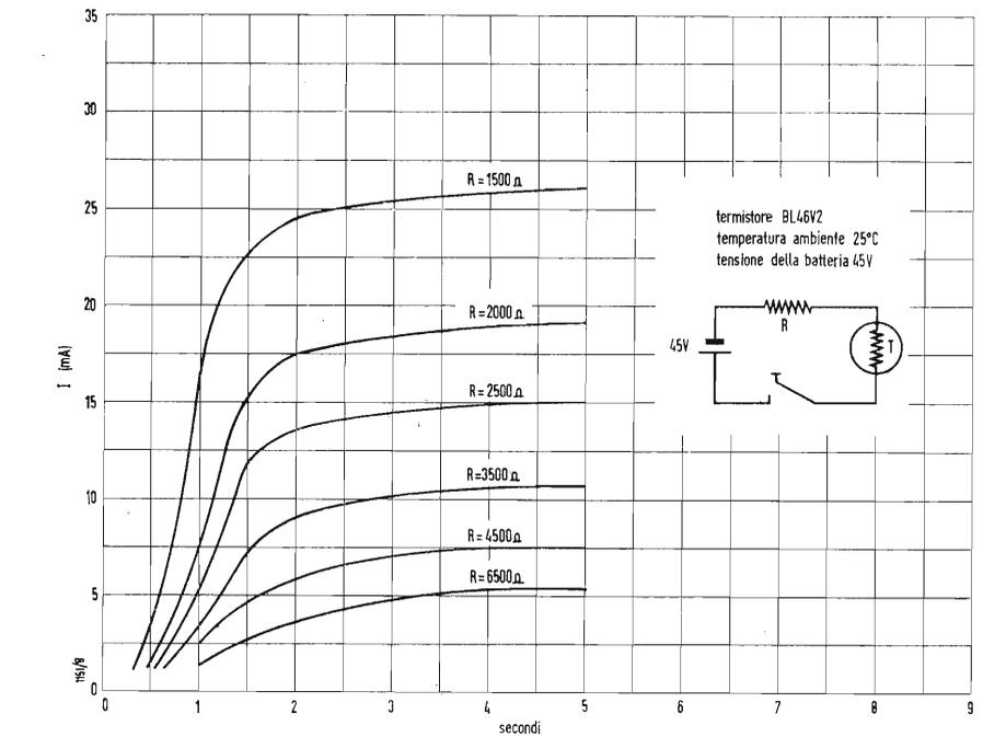
Fig. 3 - Quando si tengono fissi tutti gli altri elementi del circuito e si varia la resi- stenza si ottengono le caratteristiche dinamiche del termistore.
