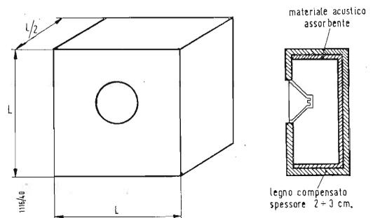
Fig. 5 - Mobile per altoparlante completamente chiuso. Permette di assorbire le onde sonore emesse dalla parte posteriore dell'altoparlante.
