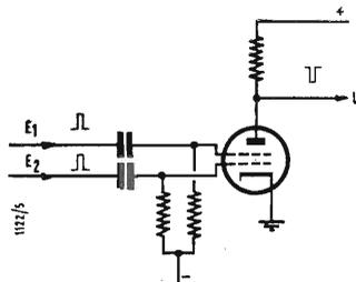
Fig. 2 - Circuito elettronico a coincidenza.
