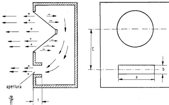
Fig. 15 - Principio di funzionamento del mobile bass-reflex.
