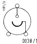
Le caratteristiche sono le seguenti: sensibilità massima allo spettro = 8000 Å; superficie del catodo = 3,23 cm<sup>2</sup>; tensione della sorgente = 90 V; sensibilità massima = 160 µA/lumen; coefficiente di amplificazione del gas = 12; resistenza di carico = 1 mΩ; temperatura ambiente massima = 100 °C.
