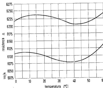
Fig. 5 - Con il circuito di compensazione in due tentativi successivi (a e b) si riducono le variazioni di resistenza della bobina entro il ± 0,24 %.
