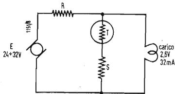
Fig. 6 - Circuito per la regolazione di tensione.
