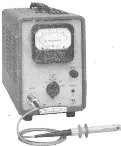
La HEWLETT-PACKARD Co., secondo un principio tecnicamente elementare, ma di eccezionale eleganza, ha realizzato uno strumento che consente misure di correnti continue da 0,3 mA. ad 1 A., **SENZA DOVER INTERRUPIRE IL CIRCUITO SOTTO MISURA.**
