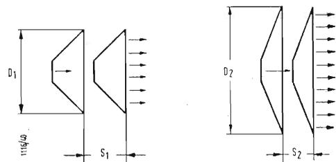
Fig. 13 - La velocità di volume d'aria impressa da un altoparlante avente un diaframma di diametro  $D_1$ , è uguale a quella di un altoparlante avente un diaframma di diametro  $D_2 < D_1$ , purchè lo spostamento  $s_1$  che questo diaframma subisce sia relativamente più grande dello spostamento  $s_2$  che subisce l'altoparlante più grande.
