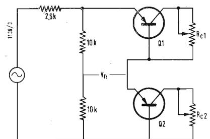
Fig. 2 - Adattamento di due diodi-transistore mediante una resistenza  $R_c$  tra base e collettore.
